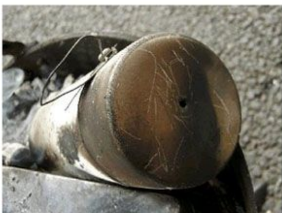
17. 煙が出無くなったら炭化終了
