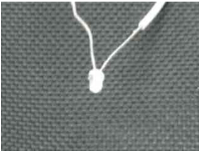
写真 19. LED は点灯しない。 点灯しなかった方は、がっかりしてください。 LED が点かなかった方はダイオードの線を二本共つなぎなおしてください。
