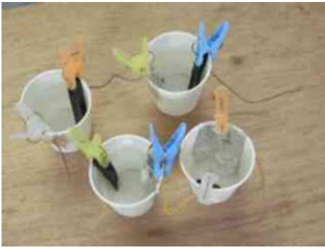
写真 11.最後に右側のアルミにも線を付けます
