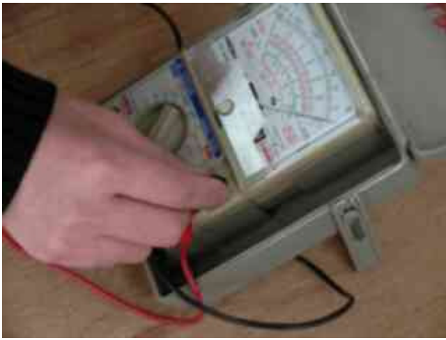
写真 23.先端を ショートしながら右側のダイヤルをまわして針が右側のゼロの位置に調整します
