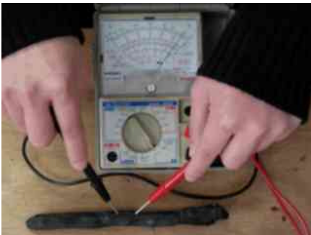
写真 27.カシの白炭(備長炭)を測ってみます 電気は流れましたか
