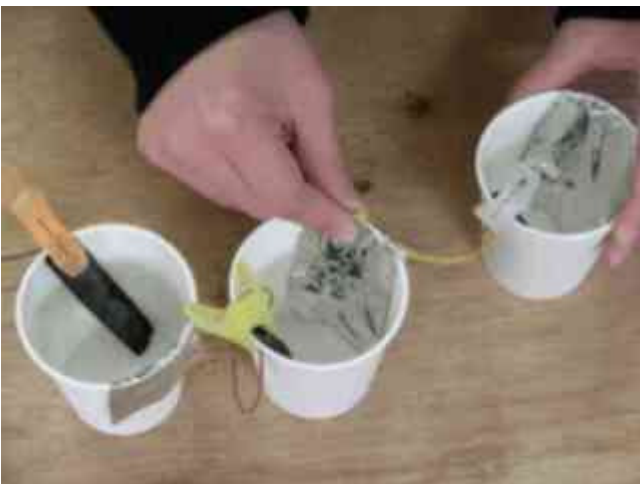
写真 9.左の炭から出ている線を右のアルミにつける
