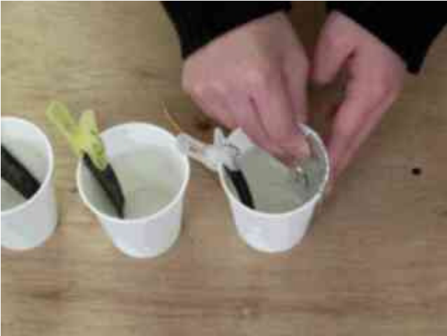
写真 7.アルミ箔を底に着くように入れ外側に折る
