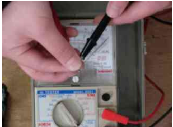
写真 22. \times 1 に合わせ棒の先端を手でショートさせます
