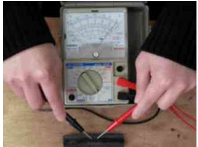
写真 26.竹の白炭を測ります 電気は流れましたか
