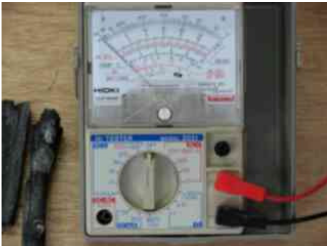
写真 21. 回転式(ロータリー)の SW 上が off です
